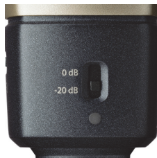
Abbildung 2: Wahlschalter für Vorabschwächung
